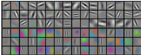
AlexNet 第一层学到的 96 个 11 \times 11 \times 3 核
